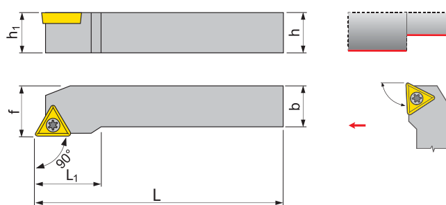
Fig.: Versión a la derecha Suministro sin plaquitas de corte.
