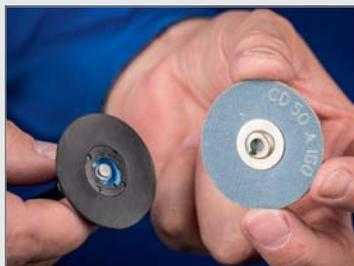
La combinación COMBIDISC de soporte y hoja abrasiva, que soporta grandes cargas gracias a la unión atornillada (metal/plástico), puede utilizarse para todas las tareas de acabado de superficies, desde el mecanizado en bruto hasta el pulido. El portadiscos en los distintos grados de dureza garantiza la transferencia de la presión de contacto deseada a la superficie o contorno a mecanizar.
