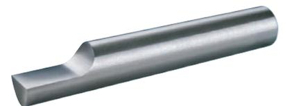
**Aplicación:** con el rectificado correspondiente pueden emplearse de forma idónea para el grabado de caracteres y contornos, así como para el torneado de piezas perfiladas y para el fresado en copiado en la construcción de matrices y moldes. La sección por la mitad preperfilada se adapta en poco tiempo al uso previsto mediante el rectificado de acabado.
