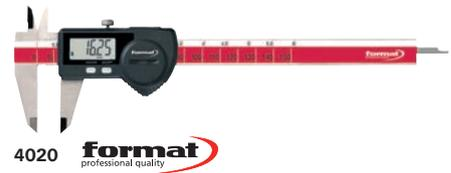
**4020 1330** – **1360** Guías lapeadas, altura de los dígitos del display LCD 8,5 mm, con salida de datos RS232, USB y Digimatic. Conexión automática, bloqueo de palpador para ajustar la posición cero.
