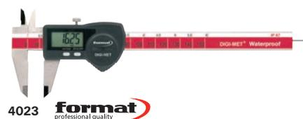
**4023 1400** – **1411** Guías lapeadas, con tornillo de retención, altura de los dígitos del display LCD 11 mm, superficies de medición elevadas para proteger la regla graduada, rascador de suciedad en la corredera. Además, con función de preajuste (ajuste previo de los valores de medición), cambio del sentido de conteo y bloqueo de palpador para fijar la posición cero.
